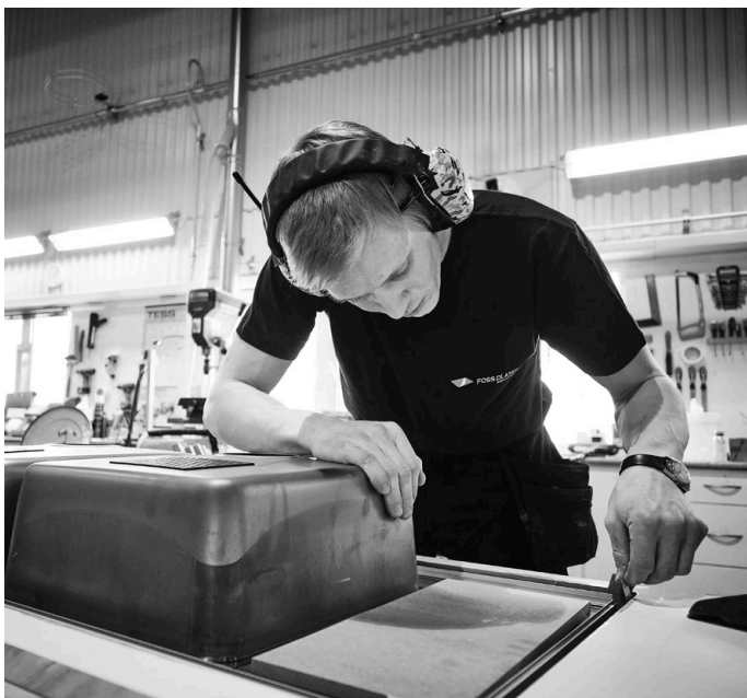
Underliming av vask utføres av våre fagarbeidere.
